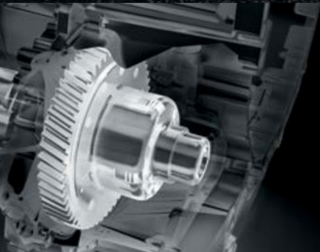
Abarth D.A.M. (μηχανικό διαφορικό περιορισμένης ολίσθησης), διαθέσιμο μόνο σε χειροκίνητο κιβώτιο ταχυτήτων.
