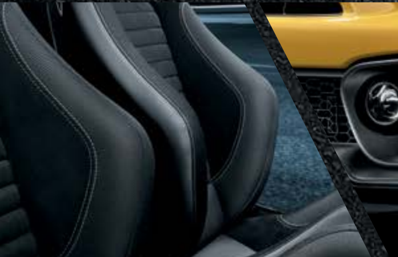
Καθίσματα Abarth Corsa από την Sabelt με δέρμα και Alcantara® με σκελετό carbon fibre.
